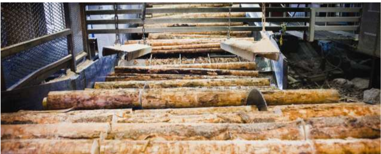
I kapsågen vid Rottneros Bruk sågas massaveden upp i längder på en meter innan de slutbarkas och går till slipverken.
