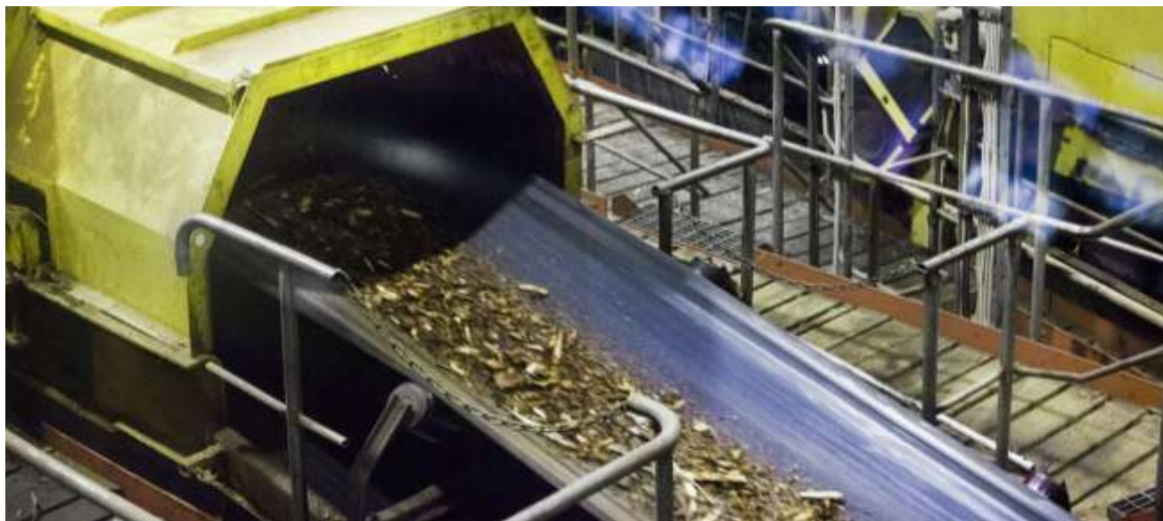
Den massaråvara som används vid Vallviks Bruk är i form av flis. Cirka 70 procent av flisen tillverkas av rundved vid bruket och resterande del köps som flis från sågverk.
