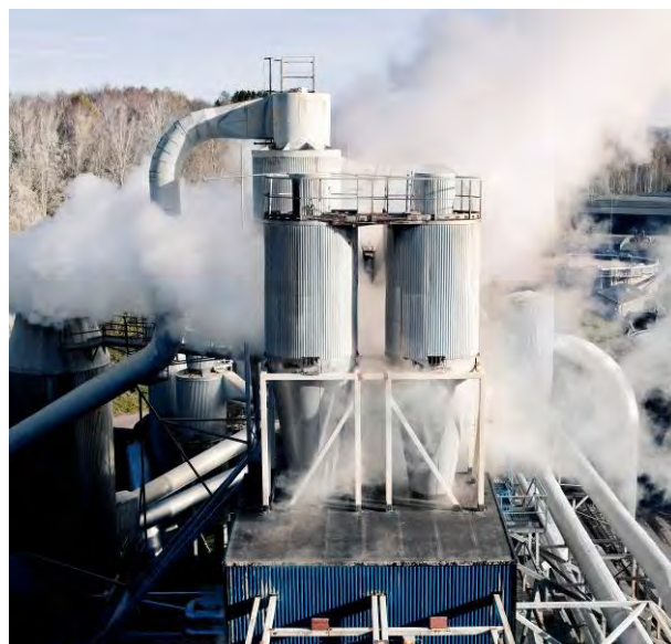
I flingtorken vid Rottneros Bruk torkas pappersmassan innan den pressas och förpackas i balar.
