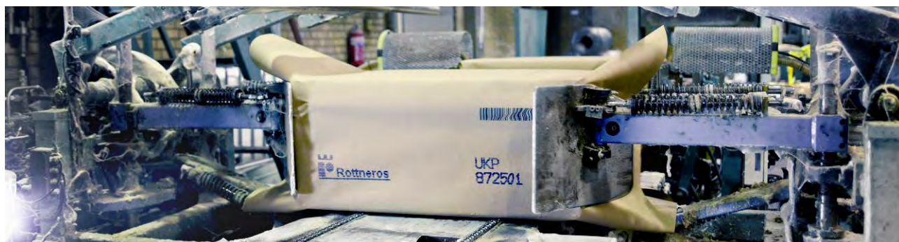
Limning av balar med oblekt massa vid Vallviks Bruk som producerar långfibrig kemisk sulfatmassa.
