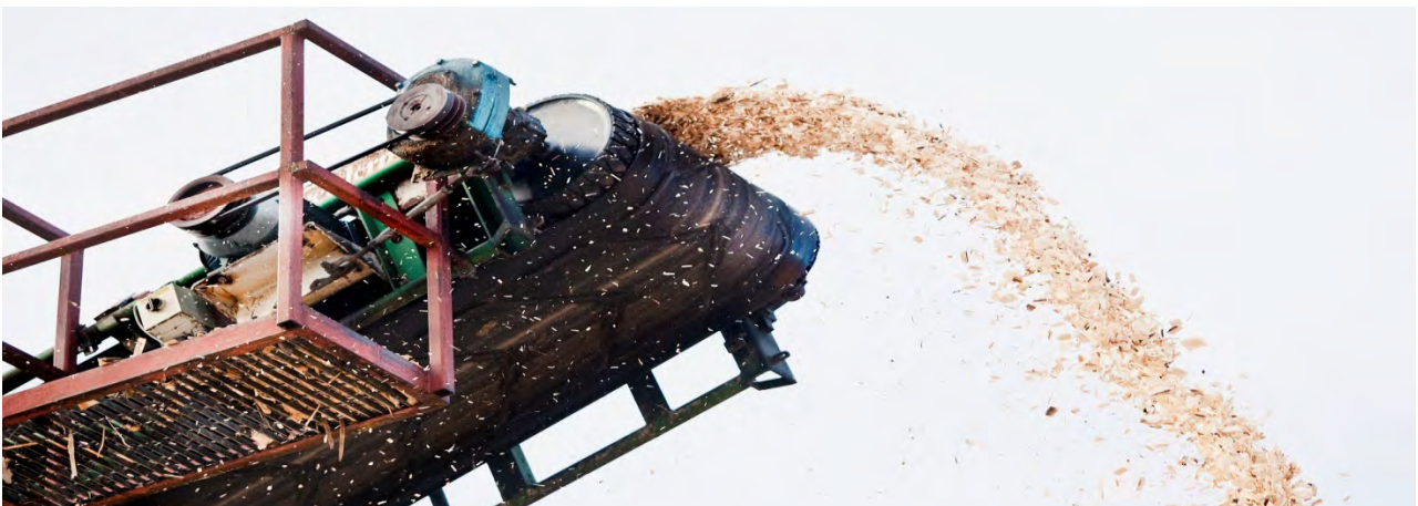
Den massaråvara som används vid Vallviks Bruk är i form av flis. Cirka 70 procent av flisen tillverkas av rundved vid bruket och resterande del köps som flis från sågverk.
