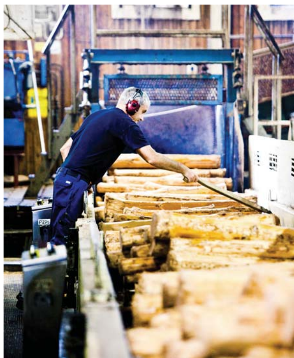
Första fasen av malningen av ved vid sliperiet i Rottneros.
