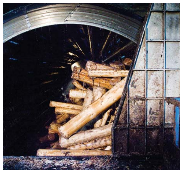
Efterbarkning i barktrumman i sliperiet vid Rottneros Bruk.
